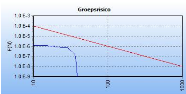
Figuur 15: De fN-curve voor deze kilometer leiding (leiding W-528-01 inclusief de verlegging).
