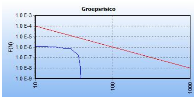
Figuur 12: De fN-curve voor deze kilometer leiding (leiding W-528-01 exclusief de verlegging).
